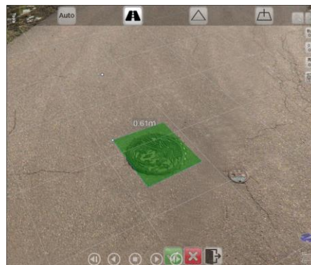
例) メッシュ計測による面積計測
