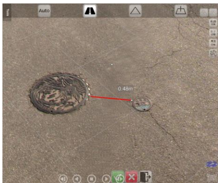
例) メッシュ計測による距離計測 計測開始地点を左クリック後、 計測終了地点を左クリック
